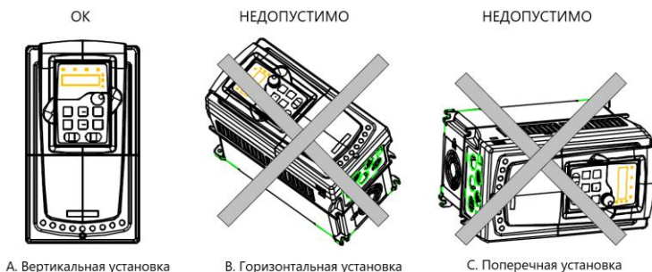
Рис. 4-1 Направление установки
