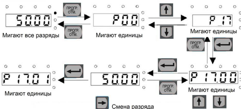
Рис. 5-5 Схема просмотра параметров состояния ПЧ
